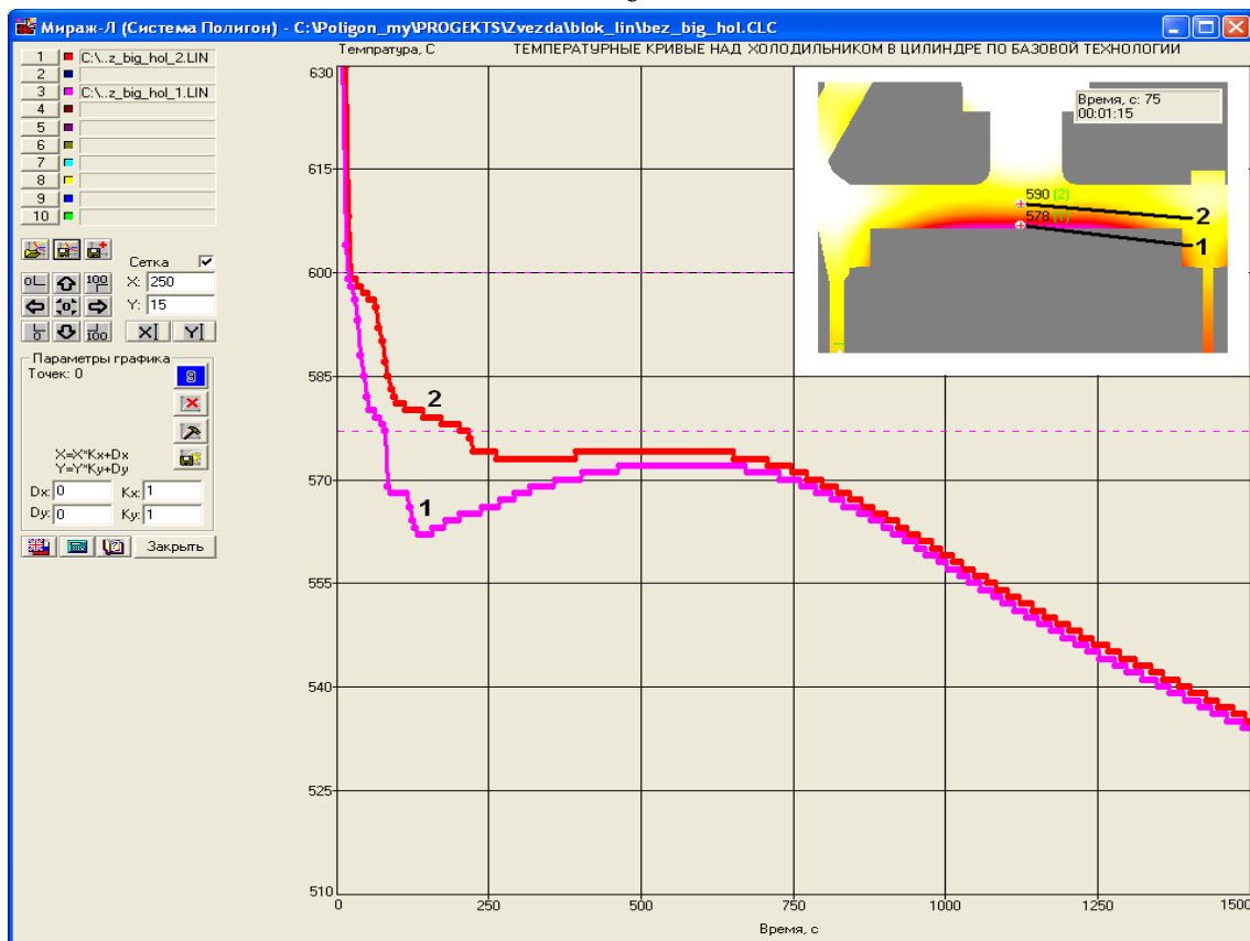
Рис. 2.6. Поля температур в процессе затвердевания в характерном сечении отливки а – одна из промежуточных стадий затвердевания (видно зарождение тепловых узлов в отливке, показаны температуры в нескольких точках); б – завершающая стадия затвердевания (включена оцифровка сечения отливки, показаны температуры в нескольких точках по сечению формы); в – термические кривые, снятые в различных точках в области дна камеры сжатия
